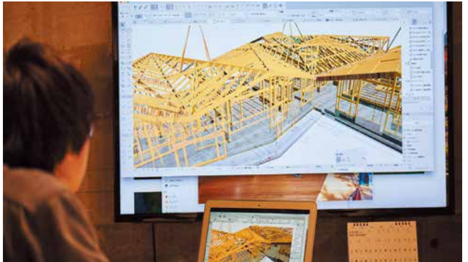
平野さんはこのプロジェクトで、BIMをはじめて活用した。「外注でBIMに詳しい設計士を入れて、教わりながら進めました。斜めの屋根に対して斜めにあたる部分などの形の操作とか、フレームがどうなるのか、どういう風に切断すればよいのかとか、すべて Archicad 上で描けたので、BIMを使わないと大変だった案件かも」。
