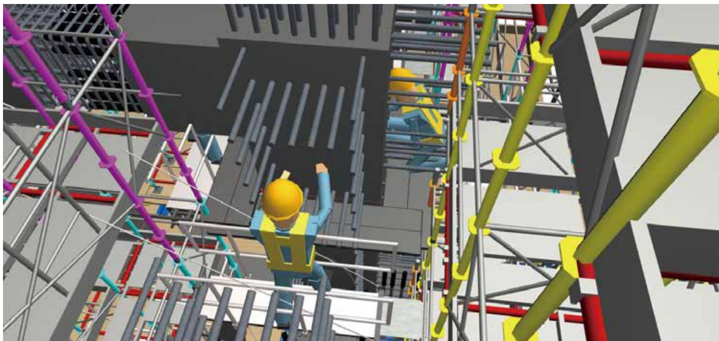
Archicad上でのPCa取付と配筋作業イメージ (安全と作業性の検討中)
