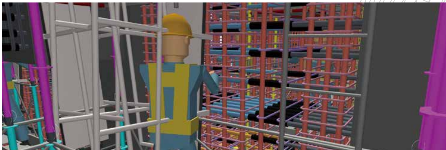
梁下端筋接続作業イメージ (安全と作業性の検討中)
