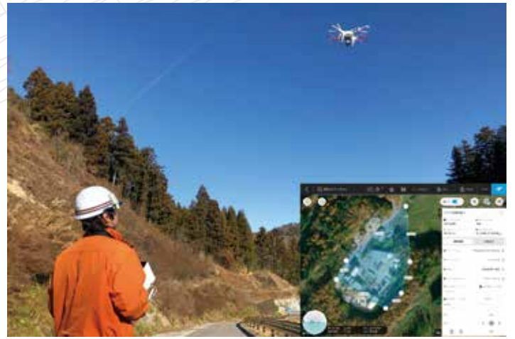
ドローンによる自動飛行測量
