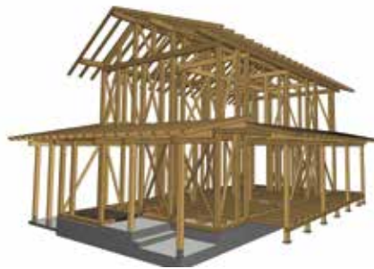
冒頭の「八木田にある家」の木造軸組構造モデル。大工さんにBIMxで見てもらった
