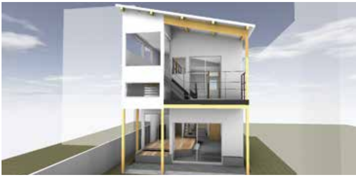
スキップフロアを設けたプラン。二階の白壁の裏にあるフロアがせり上がっている
