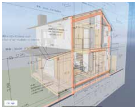
木造軸組構造と意匠設計の取り合いもBIMなら一目瞭然だ
